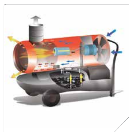
Принципиальная схема работы нагревателя серии EC
