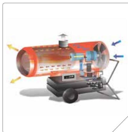
Принципиальная схема работы нагревателя серии PHOEN
