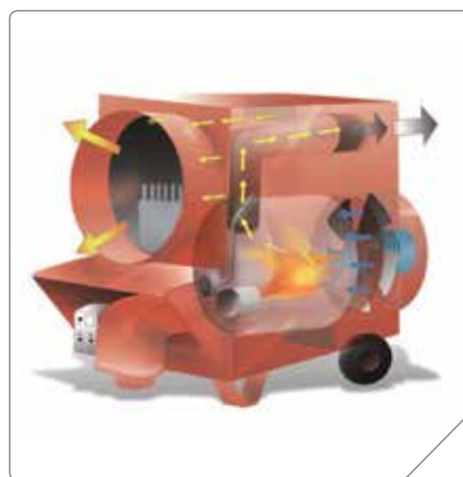
Принципиальная схема работы нагревателя серии JUMBO
