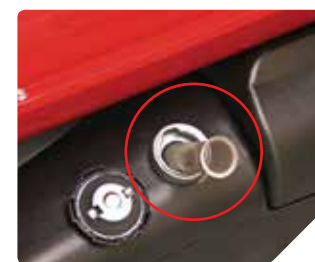
Съемный топливный фильтр
